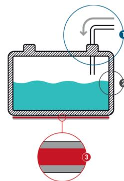
La caldaia è uno dei componenti principali della macchina, al suo interno si crea il vapore. Il calcare è il nemico principale della caldaia, Maxima utilizza delle tecnologie studiate per ridurre i rischi di ostruzione e malfunzionamento.
